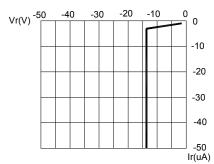
FIG.3 BLUE & GREEN REVERSE CURRENT VS. REVERSE VOLTAGE.
